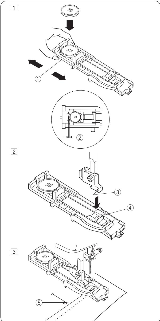
Размер петли автоматически определяется по размеру пуговицы, помещенной в лапку для автоматической петли R.
