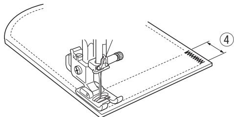
Закрепка используется для усиления области карманов, шаговых швов, шлевок и т. д., где необходима дополнительная прочность.
