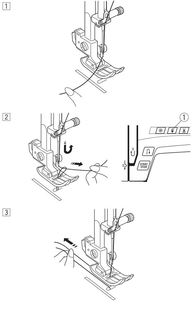
После автоматической обрезки нити или заправки шпульки, вы можете начать сразу шить без вытягивания нижней нити.
