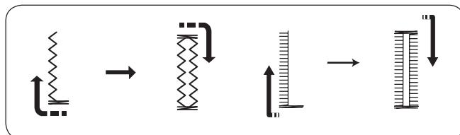
Машина сначала прошьёт переднюю закрепку и левую сторону петли.
