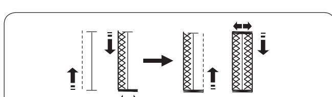
Машина сначала прошьёт переднюю закрепку и левую сторону петли.
